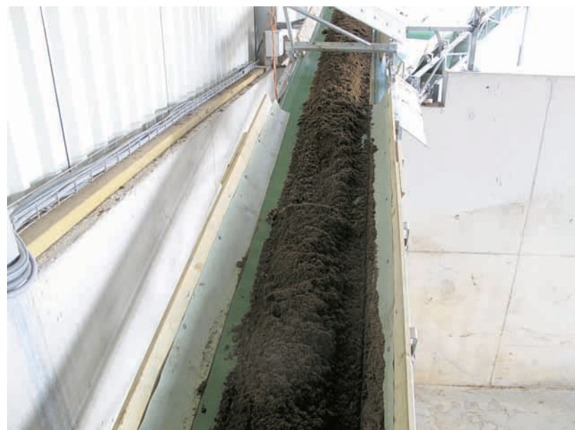
Het gecomposteerde product dat uit de trommel komt wordt afgevoerd met een band.
